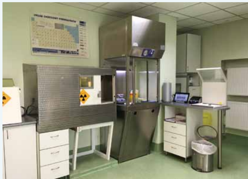
Ryc. 2. Komora laminarna, śluza podawcza i generator germanowo-galowy. Wyposażenie Pracowni Radiochemicznej w Zakładzie Medycyny Nuklearnej Narodowego Instytutu Onkologii – Państwowego Instytutu Badawczego w Warszawie
